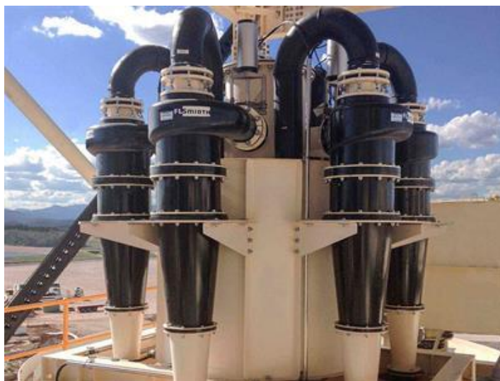
รูปที่ 5 การแยกถ่านหินให้สะอาดด้วยอุปกรณ์ Hydrocyclone [14]
