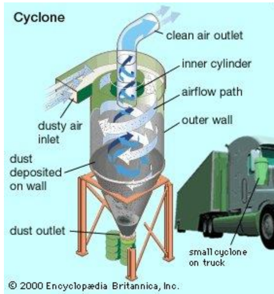
รูปที่ 23 กระบวนการทำงานของ Cyclones [40]
