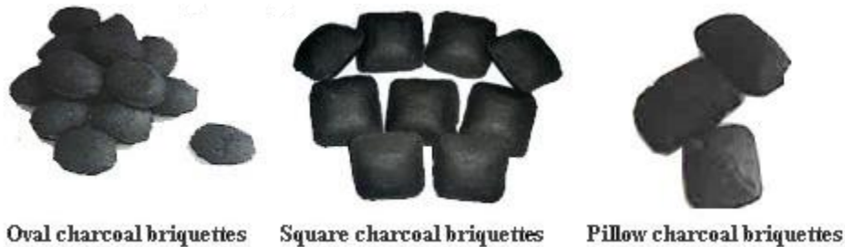
รูปที่ 7 รูปแบบการอัดก้อนถ่านหินเพื่อใช้เป็นเชื้อเพลิง [19]
