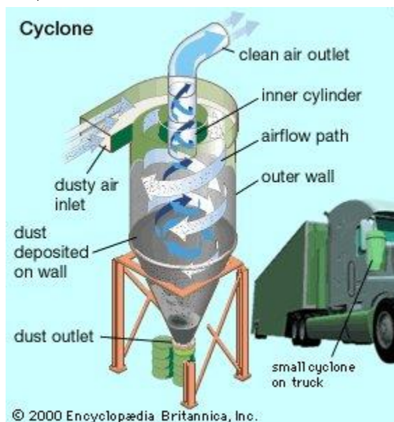
รูปที่ 4-26 กระบวนการทำงานของ Cyclones [50]
