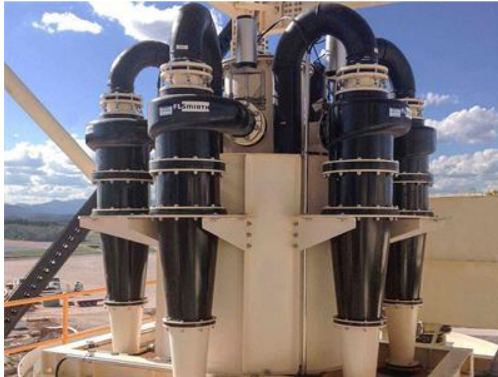
รูปที่ 4-7 การแยกถ่านหินให้สะอาดด้วยอุปกรณ์ Hydrocyclone [24]
